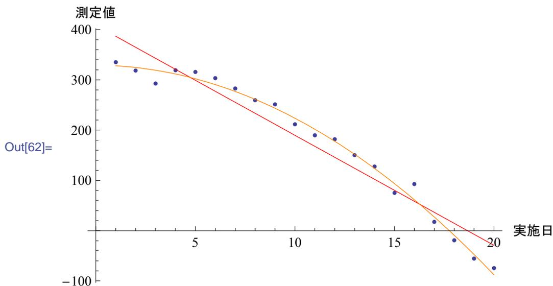
同じ形のリストをたくさん作るのに適している組込み関数Tableを活用することで, 幾つもの次数によるフィッティングを同時に作らせることも出来ます. 下記では, 生成データの回帰直線(1次多項式への最小二乗法による当てはめ)の他, 2次から4次までの各多項式への最小二乗法による当てはめを計算させています. ここでの
